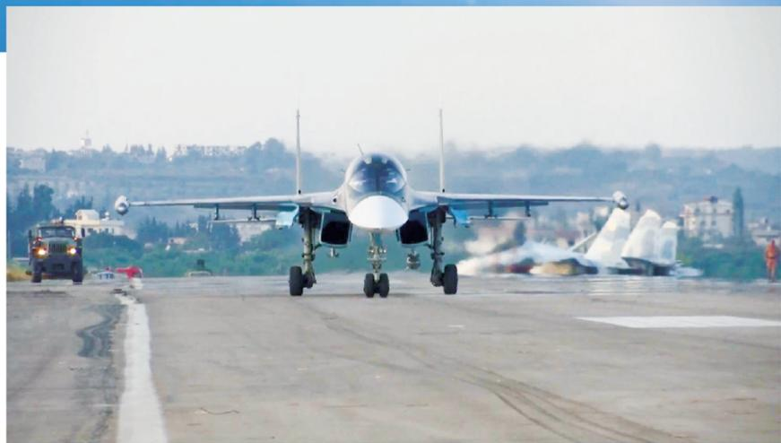
苏-34携带一枚未投的KAB-500S-E制导炸弹着陆。可见该机翼尖挂载有L-175V“希比内”电子战系统吊舱。压题大图为俄空军远程航空兵图-160轰炸机飞抵地中海东部,由苏-30SM战斗机护航。
