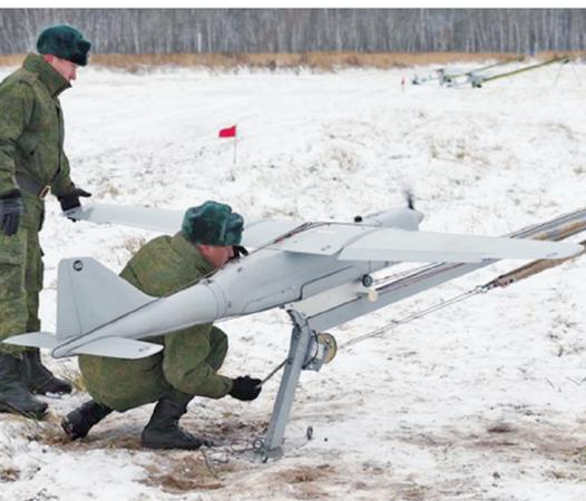
一架“海雕”-10无人机准备弹射发射。
