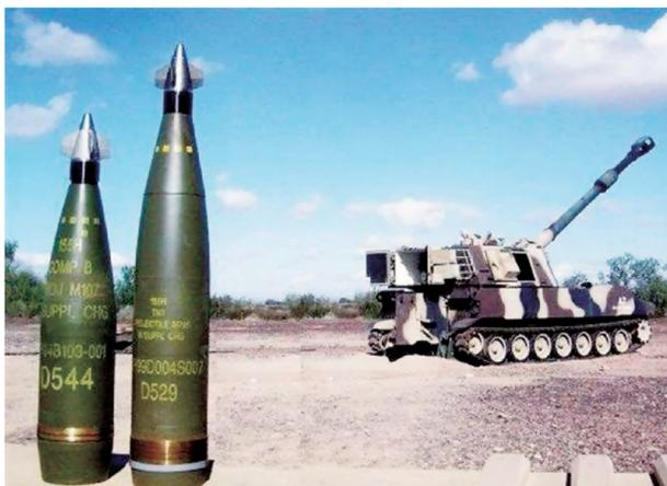
采用精确制导组件的155毫米炮弹。
