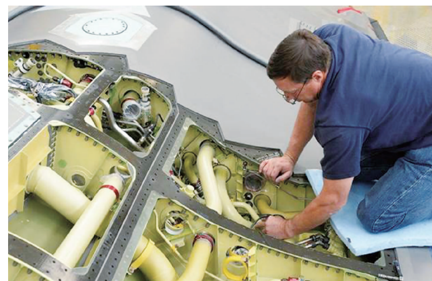
技术人员正在查看F-35因开孔尺寸不标准导致的腐蚀问题。
