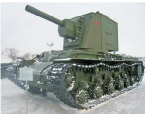
苏联二战时期的KV-2重型坦克，有着一门152毫米口径的M-10榴弹炮，这一口径无论对于当时还是现在的坦克都是非常大的。为了容纳巨大的152毫米炮，以及装填手、炮长和弹药，设计团队为其设计了一个“大脑袋”炮塔。
