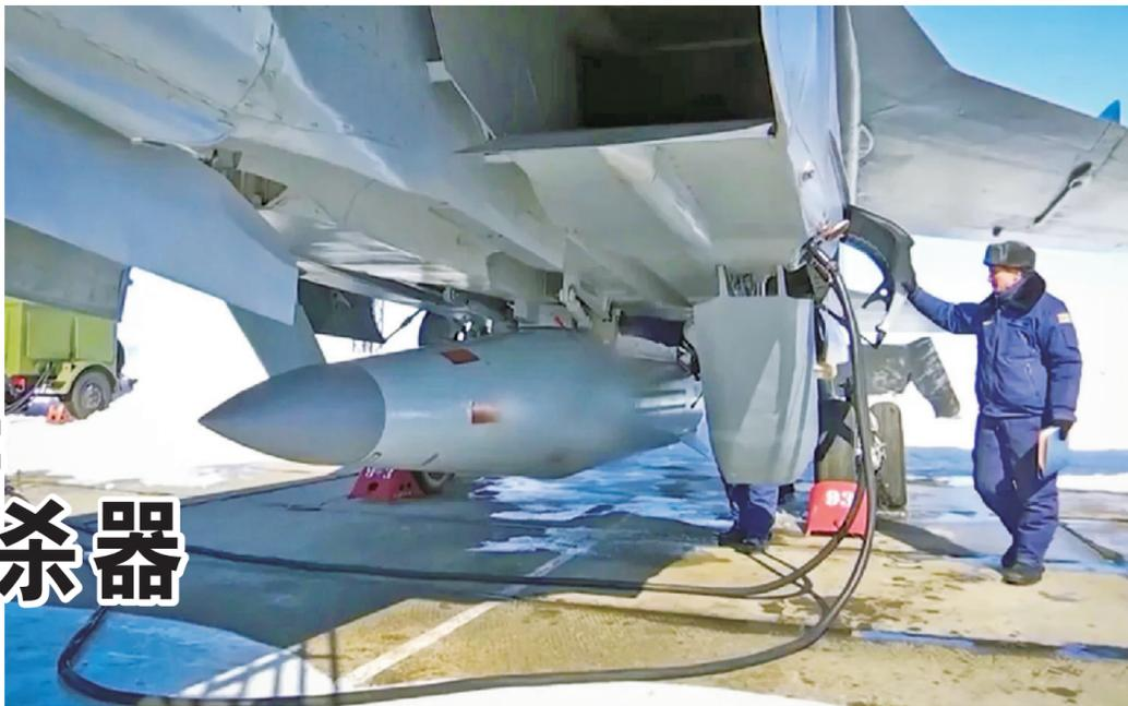
俄罗斯米格-31战机上挂载的“匕首”高超音速导弹。
