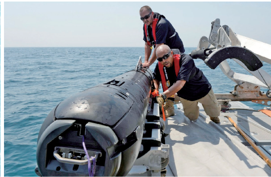
两个人就能捞起一部小型无人水下潜航器,太大的就得用到特别改装的拖船了。
