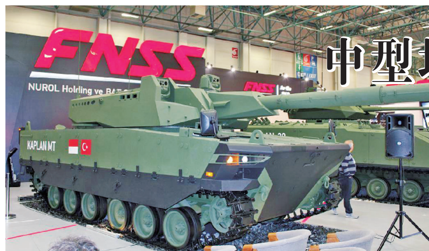
土耳其展出的“卡普兰”中型坦克,该车已更换炮塔,可以安装120毫米坦克炮
