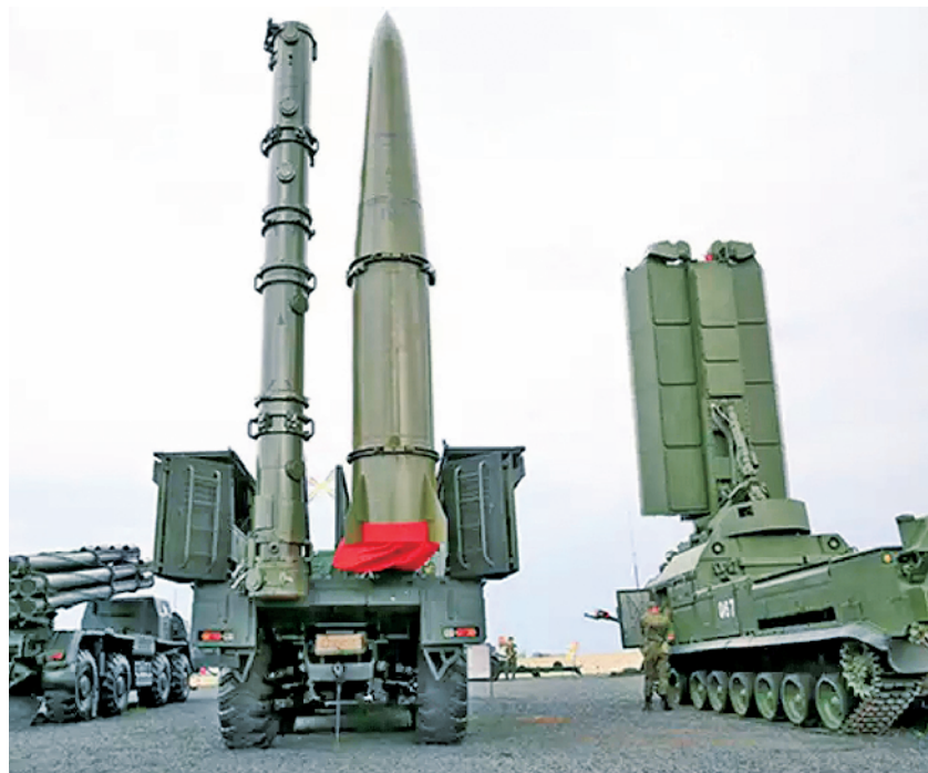
混装1枚巡航导弹与1枚弹道导弹的“伊斯坎德尔-M”导弹系统发射车(后视)
