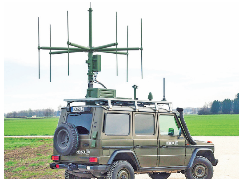
今年4月,首次亮相柏林航展的“特维尔尼斯”被动雷达探测系统
