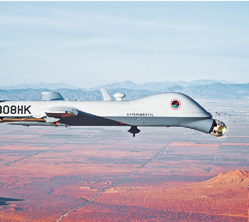
正在为美国导弹防御局进行新型探测传感器试验的一架MQ-9“死神”无人机。新型传感器装载在机头下方，朝前伸出
