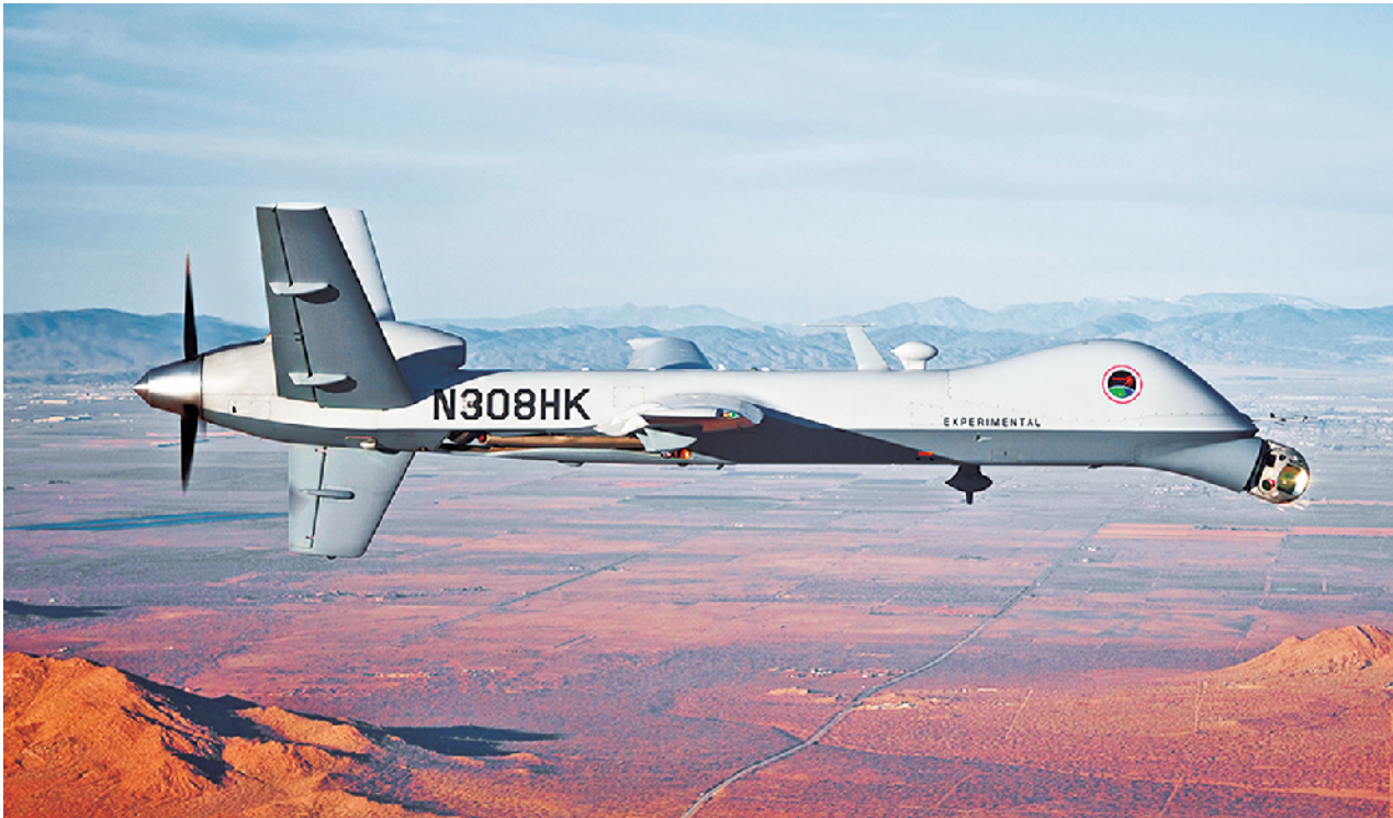
正在为美国导弹防御局进行新型探测传感器试验的一架MQ-9“死神”无人机。新型传感器装载在机头下方，朝前伸出
