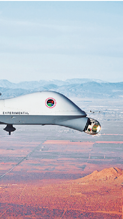
正在为美国导弹防御局进行新型探测传感器试验的一架MQ-9“死神”无人机。新型传感器装载在机头下方，朝前伸出
