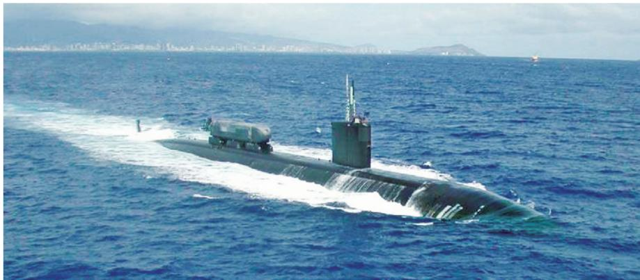
弗吉尼亚级攻击型核潜艇背部搭载的即为“先进海豹输送系统”
