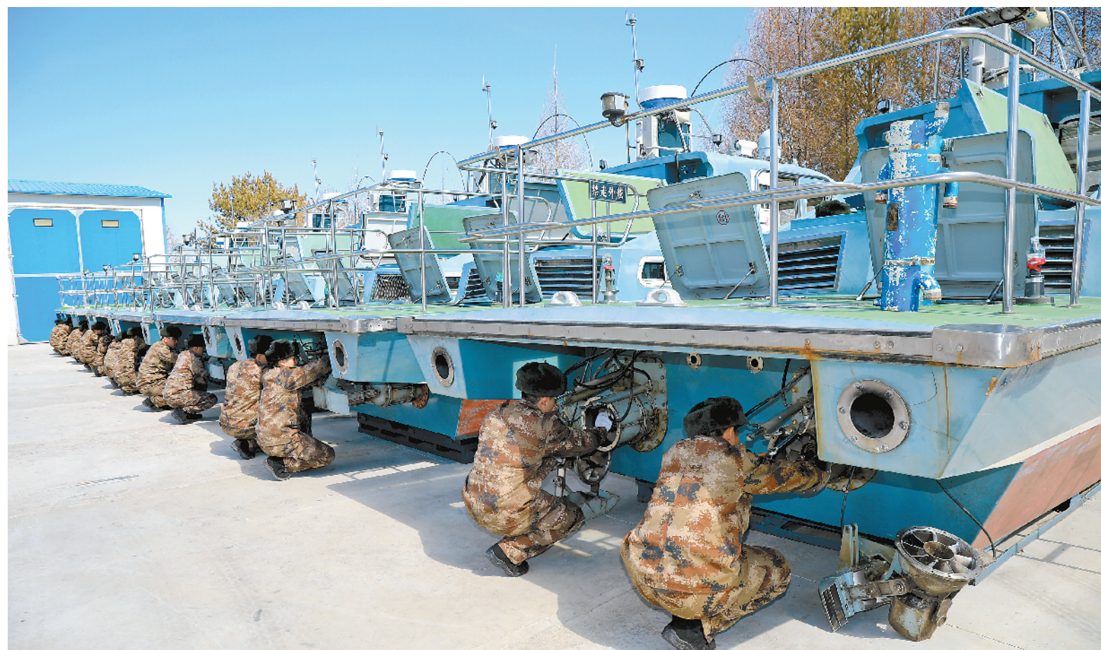
近日，陆军某边防旅旅长率队赴车场，对船艇装备进行维护保养，并采取老带新、传帮带模式开展实操训练，提升了官兵专业技能素质。图为该大队官兵对船艇水下传动轴进行检修保养。 于洪达摄
