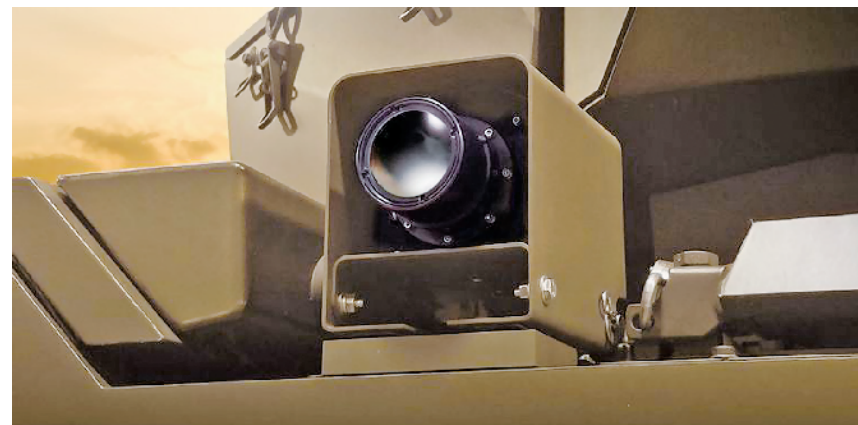
“多功能车辆保护传感器”周视系统由4个高清摄像机组成
