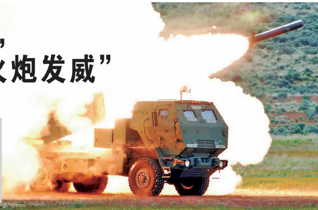
能够发射远程精确火力导弹的M142海马斯高机动多管火箭炮平台
