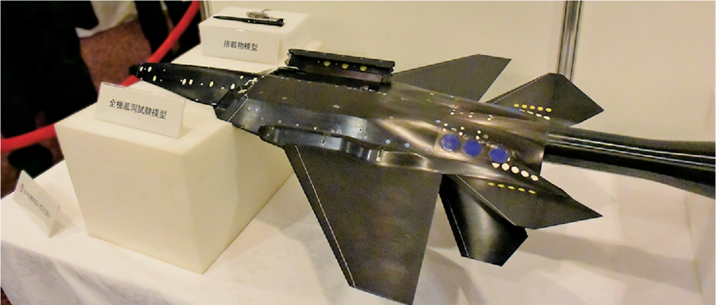
F-3战斗机风洞试验模型
