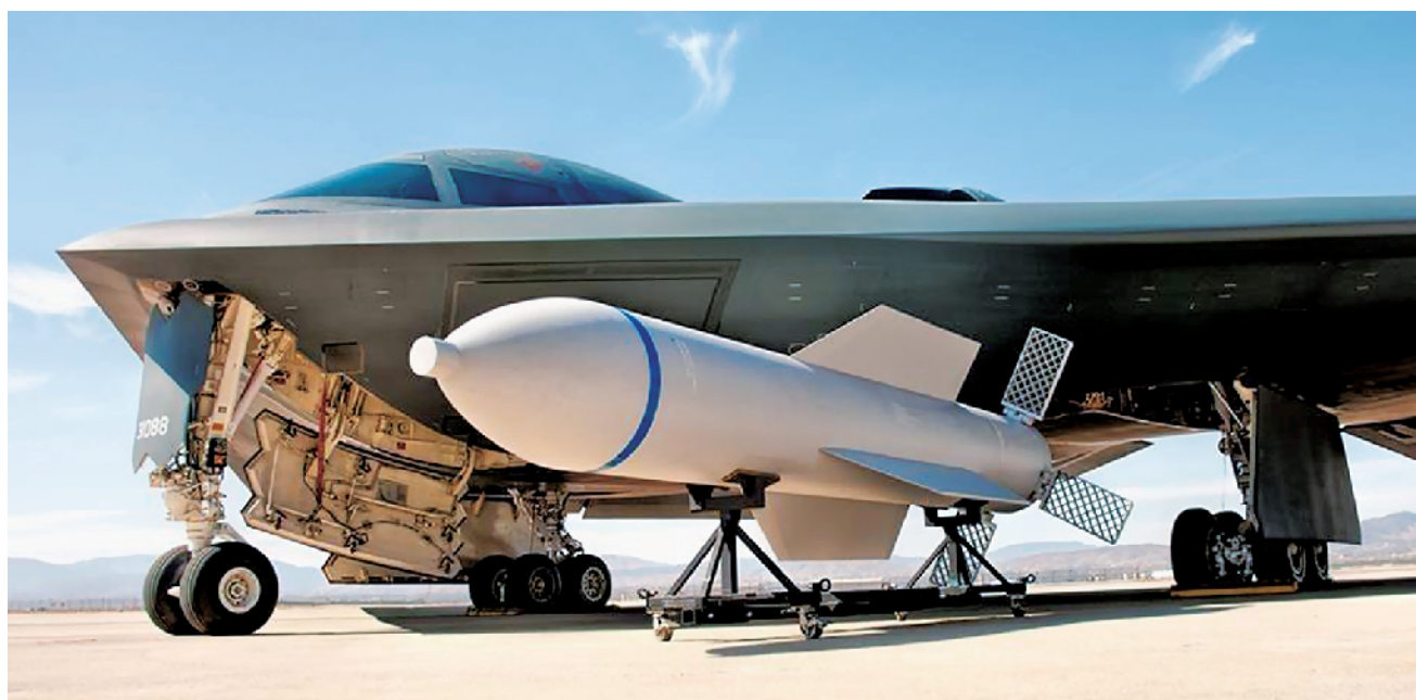
一架B-2A隐身轰炸机的内置弹舱可携带两枚GBU-57钻地弹
