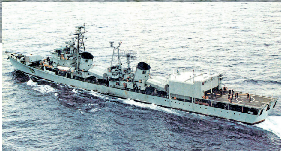
051型导弹驱逐舰首舰济南舰,加装了直升机机库和起降甲板
