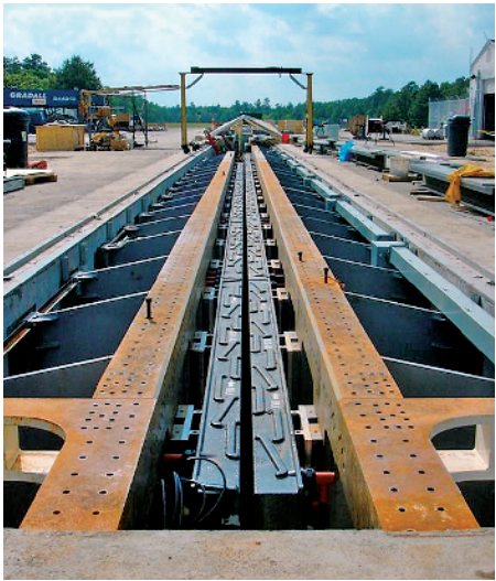
美军电磁弹射起飞地面试验装置
