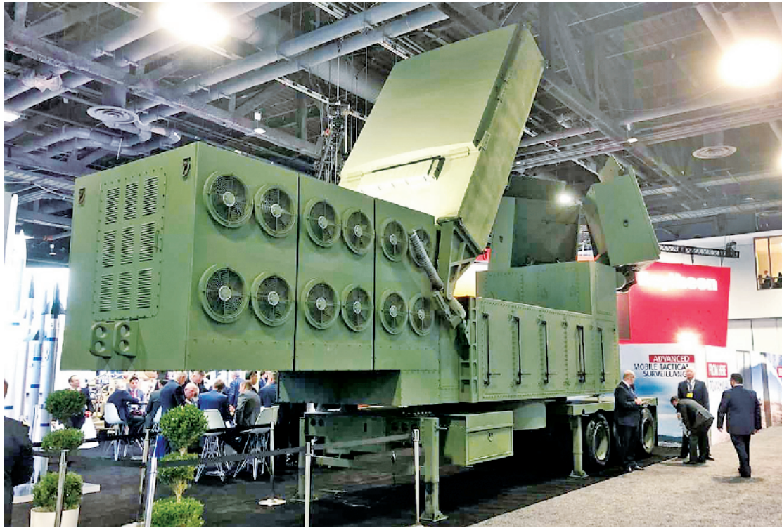
左图:雷神公司在2019年美陆军协会年会上展出的新型“低层防空反导传感器”雷达样机
