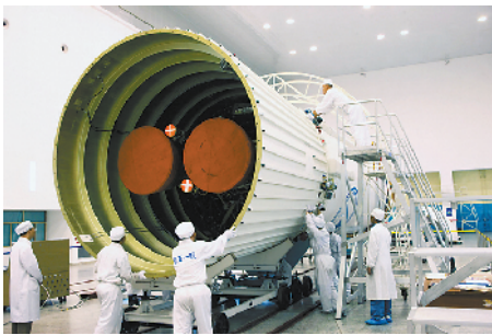
长征三号甲系列运载火箭在国家重大工程建设中发挥了关键作用，耀眼成绩背后，有一支优秀的运载火箭研发团队。这是在西昌卫星发射中心总装车间，科研人员正在对尾裙。
