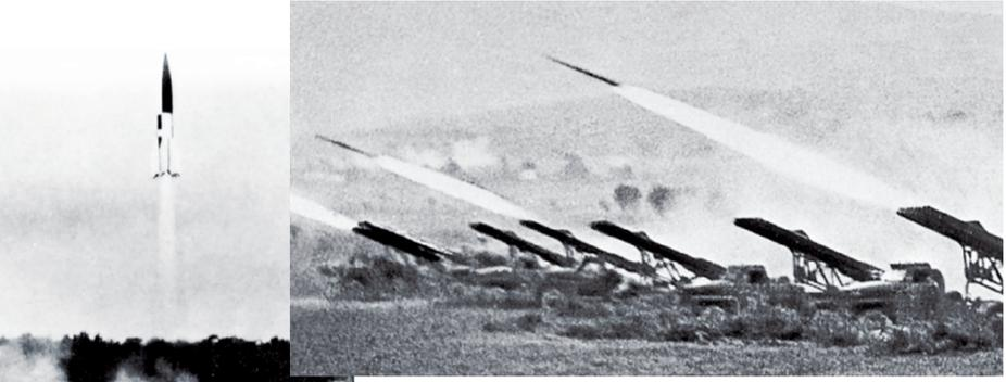
BM-13“喀秋莎”火箭炮采用倾斜发射方式
