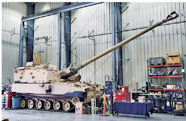
XM1299是目前炮管最长的155毫米榴弹炮
