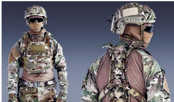
↑加拿大研发的超轻士兵外骨骼系统,这套系统包括柔性脊柱、滑动腰带、腿部支撑架,没有手臂附件
