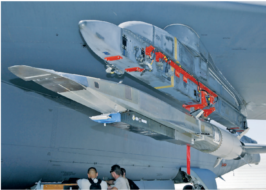
B-52战略轰炸机挂载高超音速导弹X-51A“驭波者”进行测试
