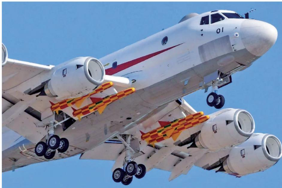
P-1反潜巡逻机可挂载4至6枚新型空舰导弹
