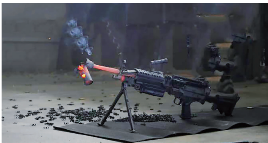
长时间全自动射击后爆裂的消音器
