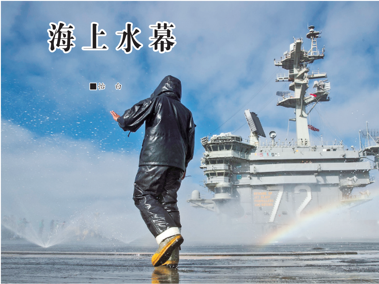
身穿防水服的地勤人员在水幕中检查甲板上的冲洗喷洒系统
