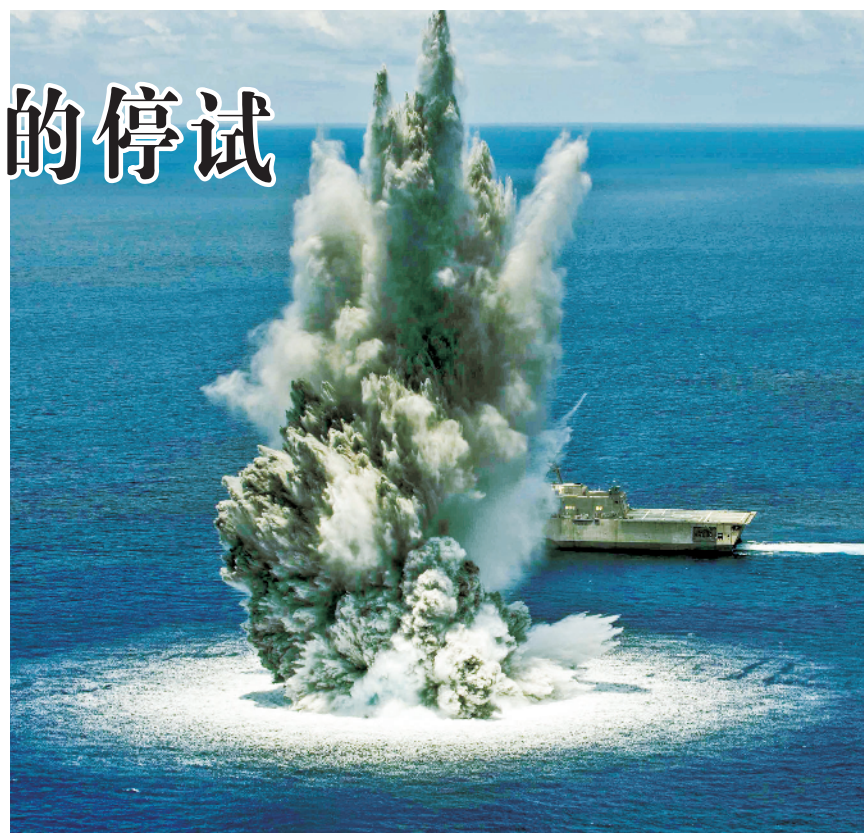
全舰冲击测试会对舰体和内部设备造成一定损坏
