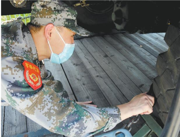
为确保军事运输投送安全,北部战区某调度中心通化军代室注重把牢第一道关口,防止因起运前捆绑不到位导致途中发生问题。图为日前该军代室参谋李赫认真检查部队装备捆绑加固情况。
