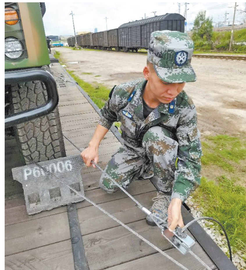
入汛以来,南部战区某调运中心昆明军代室圆满完成多批次军事运输保障任务。图为军代表王晓辉检查装备捆绑加固情况。马晓虎摄
