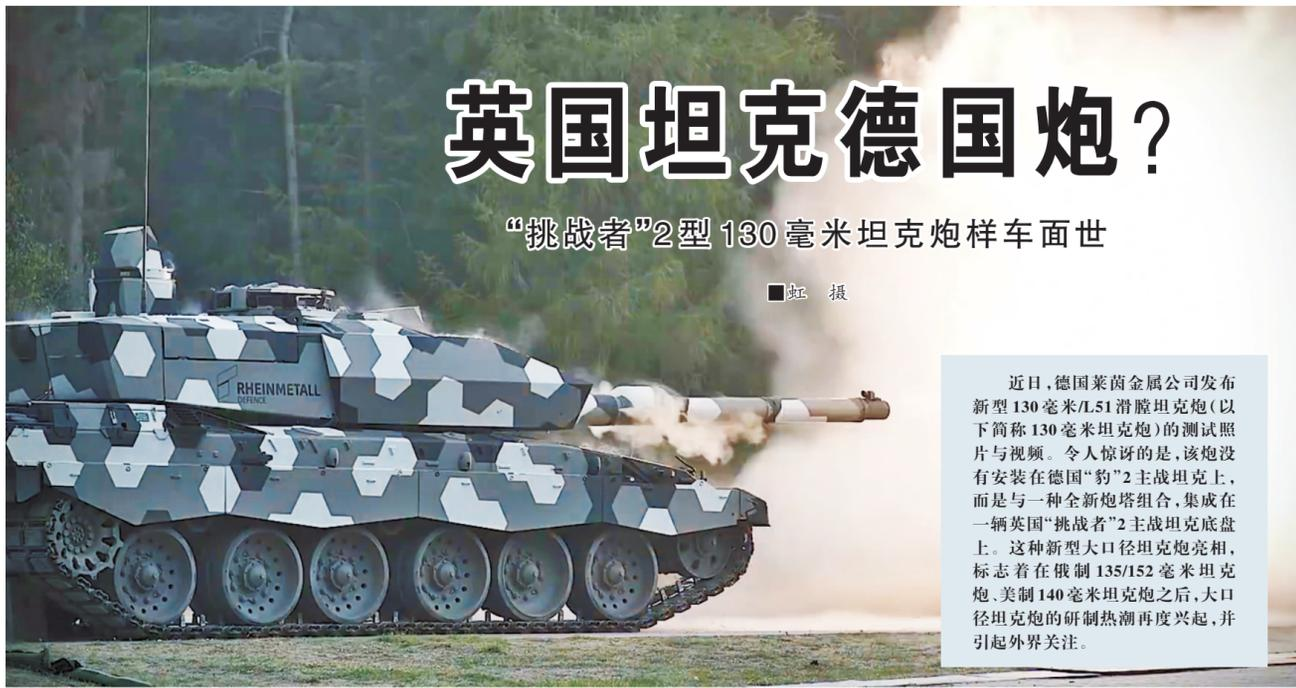
近日,德国莱茵金属公司发布新型130毫米L51滑膛坦克炮(以下简称130毫米坦克炮)的测试照片与视频。令人惊讶的是,该炮没有安装在德国“豹”2主战坦克上,而是与一种全新炮塔组合,集成在一辆英国“挑战者”2主战坦克底盘上。这种新型大口径坦克炮亮相,标志着在俄制135/152毫米坦克炮、美制140毫米坦克炮之后,大口径坦克炮的研制热潮再度兴起,并引起外界关注。
