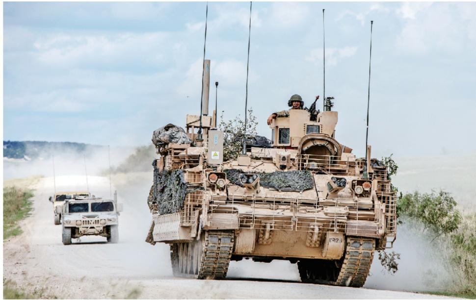
测试中的AMPV履带式装甲运输车
