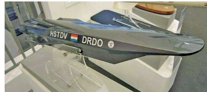
图为“高超音速技术验证飞行器”外形。该飞行器长5.6米,机体中部有一对短翼,后部是倾斜垂直尾翼,进气道长3.7米,横截面为长方形。
