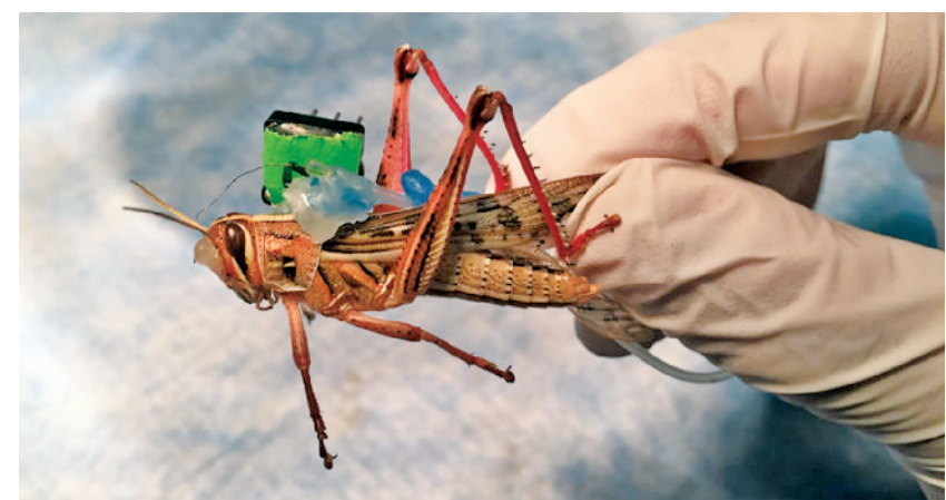
研究人员希望利用蝗虫嗅觉系统研发新型生物嗅觉传感系统,用于爆炸物探测。
