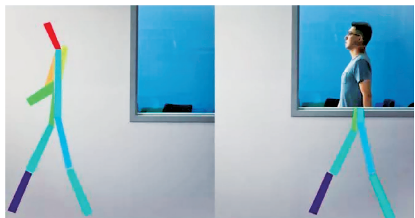
通过Wi-Fi信号识别人体目标的系统示意图
