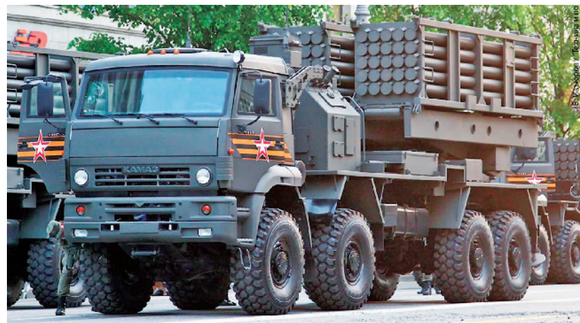
配备新型远程布雷系统的“耕作”火箭布雷车
