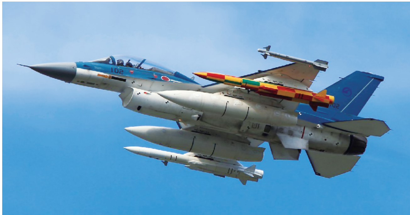
F-2战斗机挂载两枚ASM-3A超音速空舰导弹进行测试
