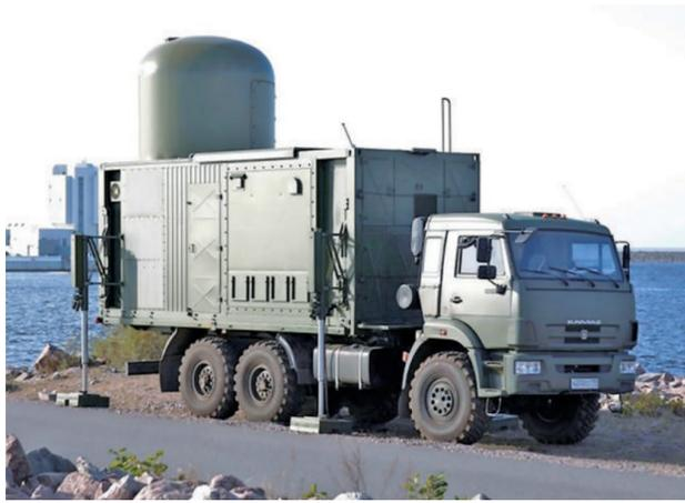
ROSC-1反无人机系统有车载式和固定式两种部署方式
