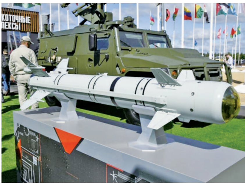
“产品305E”型多用途导弹，具备掠顶攻击坦克装甲车辆的能力
