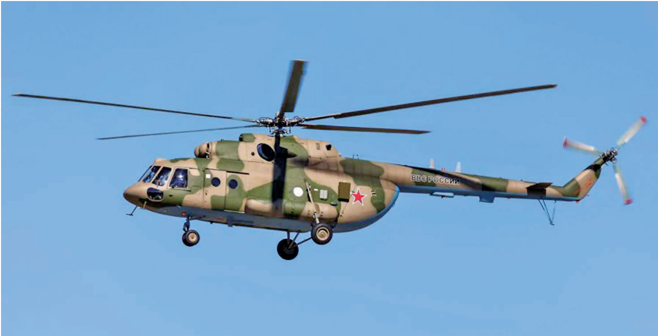
配备“杠杆-AV”电子战系统的米-8MTPR-1直升机
