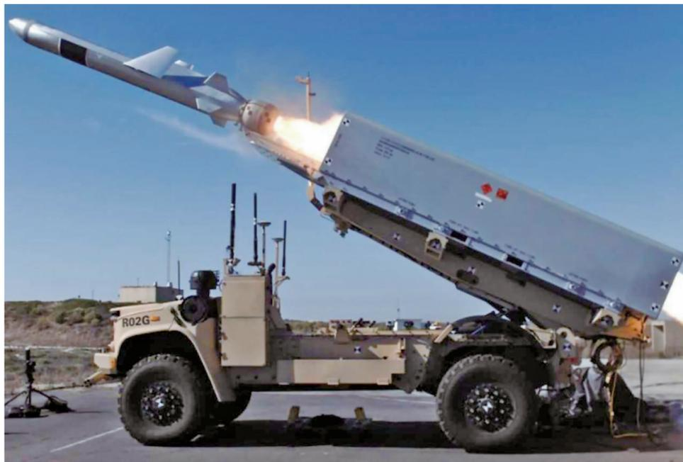
“复仇女神”岸舰导弹系统发射NSM反舰导弹瞬间
