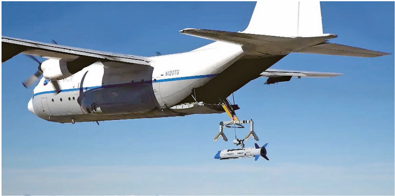
C-130运输机空中回收“小精灵”无人机(视频截图)
