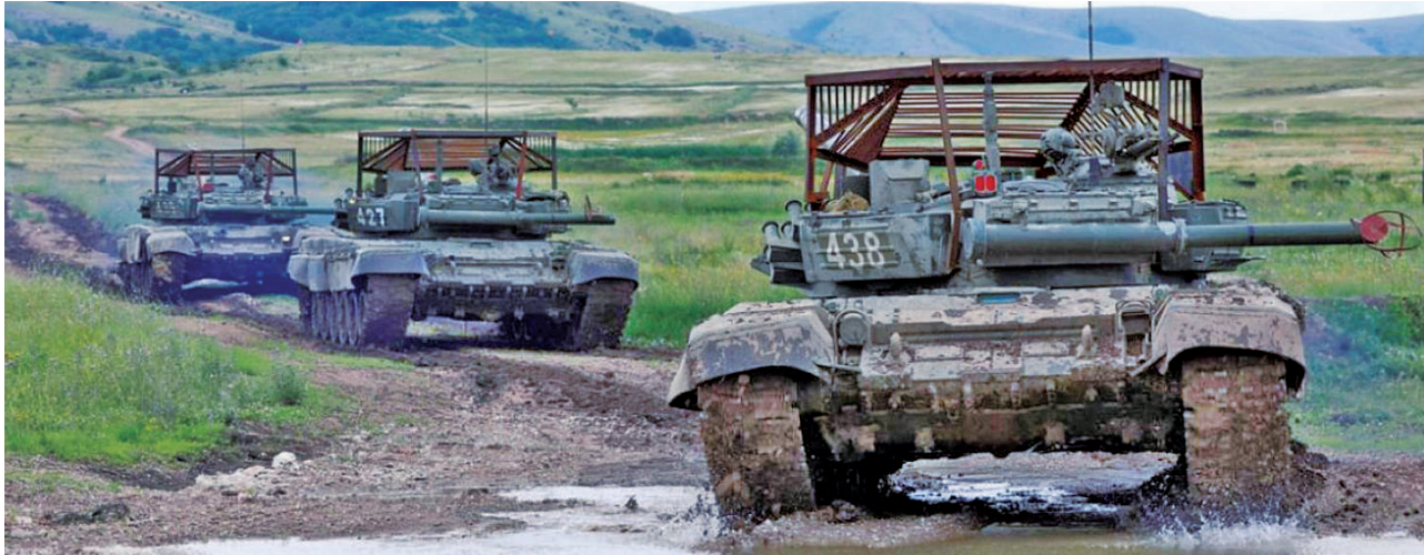
T-72B3主战坦克炮塔上加装钢质框架结构
