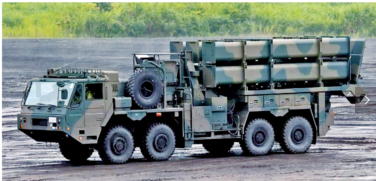
12式岸舰导弹发射车采用8×8卡车底盘,每辆发射车上可装载6枚导弹。
