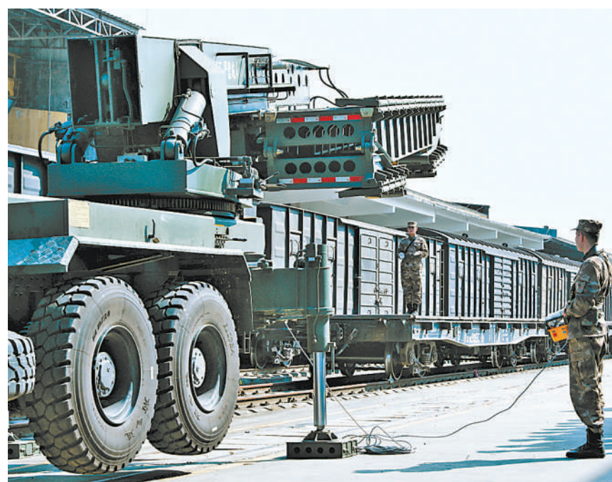
1月10日,南部战区某调度中心组织开展野战站台车开设训练,2名操作人员只需8分钟即可完成开设,大幅度提高了部队铁路运输保障效率。图为操作人员用手遥控器操纵野战站台车展开。肖兵摄
