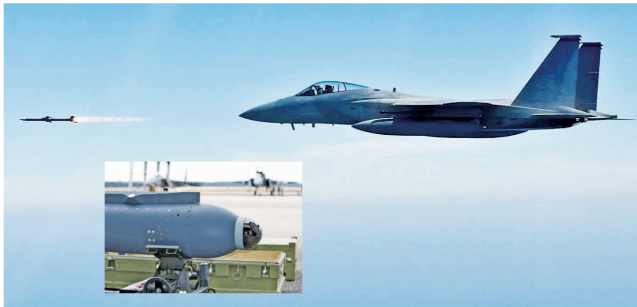
F-15C战斗机使用“军团”吊舱，引导发射AIM-120D主动雷达制导中距空空导弹。小图为“军团”吊舱。
