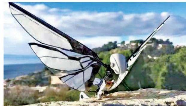
能够滑翔、通过拍打翅膀飞行和悬停的扑翼无人机。
