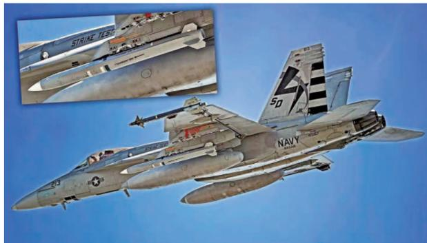
美国海军的F/A-18E型机搭载AGM-88G型导弹进行实弹打击测试。
