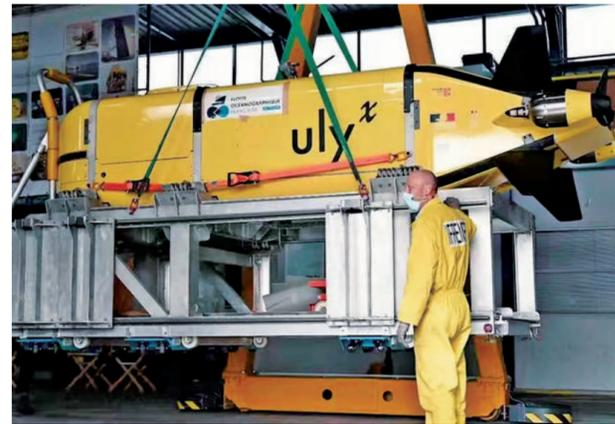
法国研发的自主无人潜航器。
