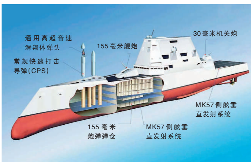
朱姆沃尔特级驱逐舰改装高超音速导弹示意图。
