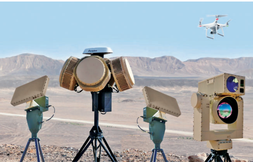
以色列拉斐尔先进防御系统公司“无人机穹”反无人机系统。
