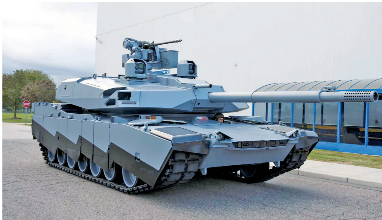
美国通用动力公司打造的“艾布拉姆斯X”下一代主战坦克技术验证车。
