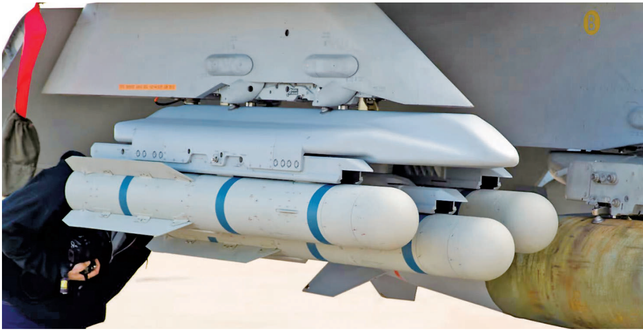
美军固定翼战斗机使用三联装挂架挂载AGM-179联合空对地导弹(JAGM)。
